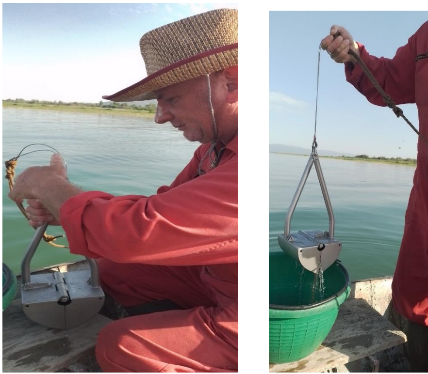
Фигура 1. Приказ на колекционирање проби од фауна на дно со van Veen-ов багер
